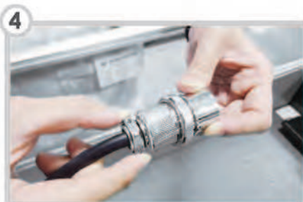
半月邊壓入(與線材不能留有間隙)
