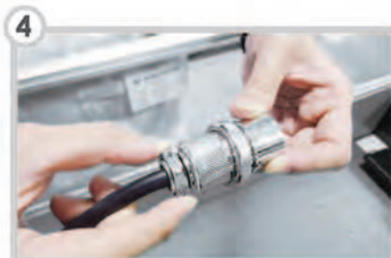
半月邊壓入(與線材不能留有間隙)
