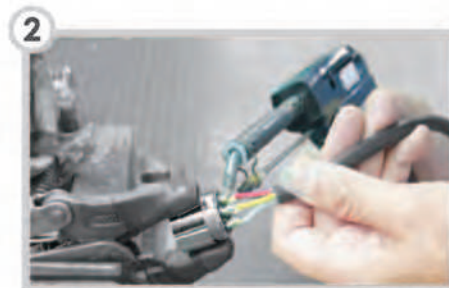
使用夾具將接頭夾持住，線材裸線與上固定體的接觸體缺口進行焊線加工
