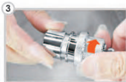
本體與上固定體對鎖，將螺紋順時針方向鎖緊(需轉動本體鎖入，非轉動接頭)
